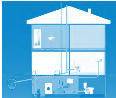
Figura 1: Exemplu de instalare cu pompă submersibilă:
