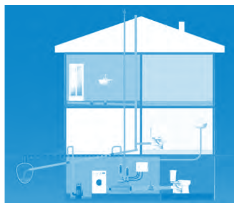
Figur 1: Eksempel på installation med dykpumpe:
