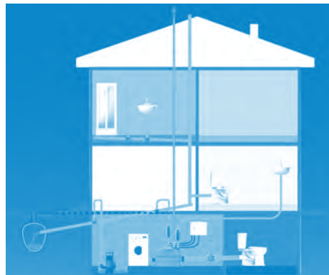
Figura 1: Exemplu de instalare cu pompă submersibilă:
