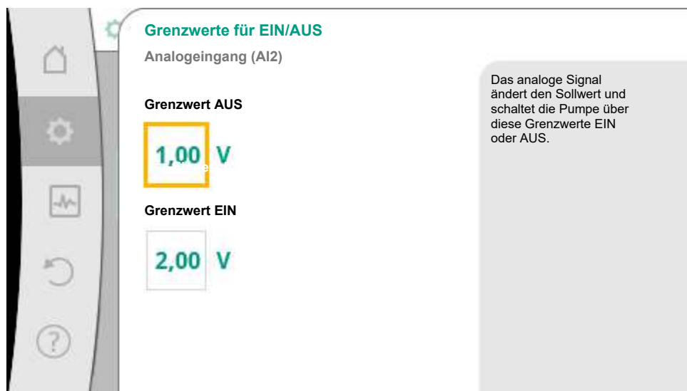
Fig. 74: Grenzwerte zur EIN/AUS-Steuerung über Analogsignale
