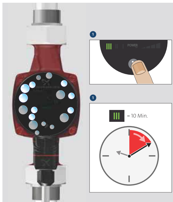
Abb. 5 Entlüften der Pumpe
