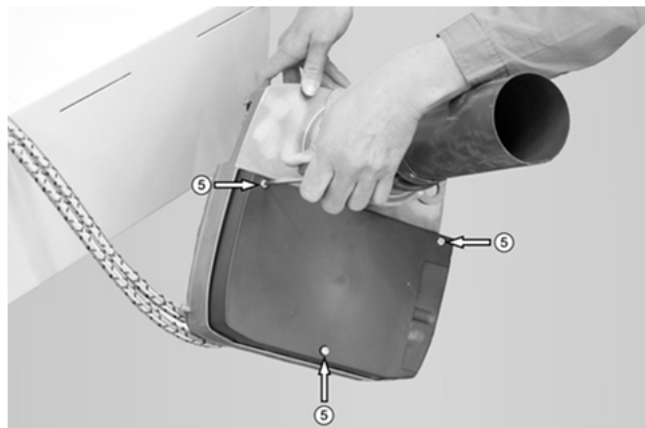
Fig. 2: Smontaggio del silenziatore di aspirazione
