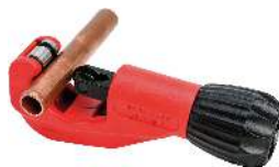
TUBE CUTTER 35, 6-35mm, DURAMAG Artikelnummer: 70027
