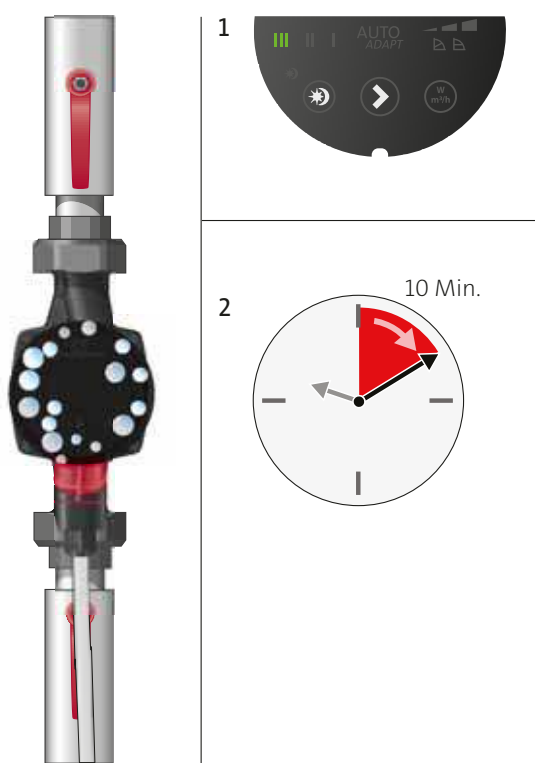
Abb. 13 Entlüften der Pumpe
