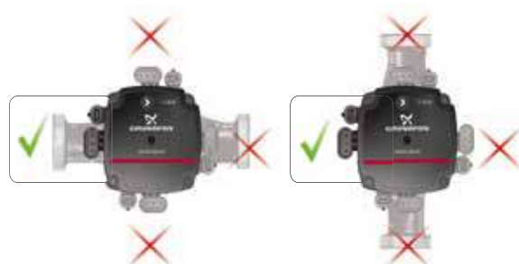
Abb. 6 Position des Schaltkastens, ALPHA SOLAR
