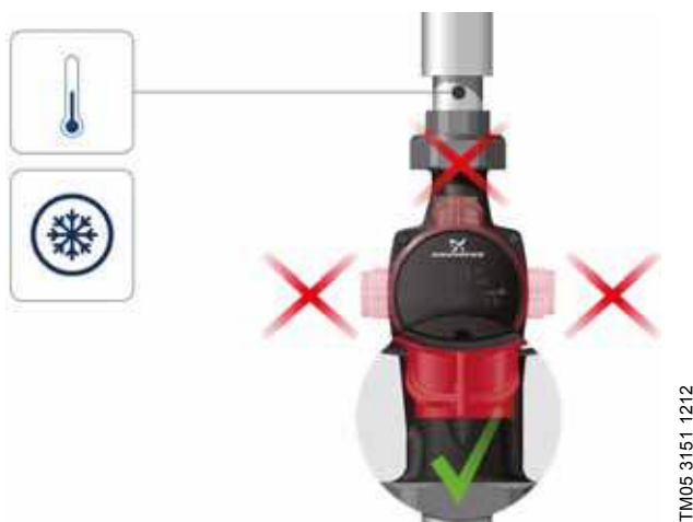
Abb. 4 Position des Schaltkastens in Klima- und Kaltwasseranlagen
