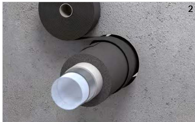
Bandage um Rohrleitung (bzw. Dämmung) legen (Lagenanzahl beachten!) und Überlappung (ca. 20 mm) verkleben.
